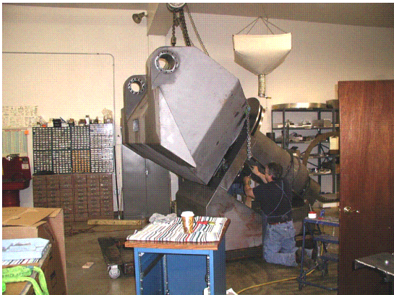
Abb. 23: Polare Achse und Gabelmontierung für das neue Sonnenteleskop NST
